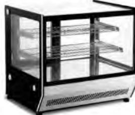
**VITRINA EXHIBIDORA CALIENTE PARA MOSTRADOR DE CRISTALES RECTOS MARCA MIGSA.** FABRICADA EN ACERO INOXIDABLE TIPO 201 EN ACABADOS ESPEJO Y CRISTAL, CAPACIDAD DE 190 L. TEMPERATURA DE 40-65°C. 2 PUERTAS POSTERIORES DESLIZABLES, 2 PARRILLAS CROMADAS. VOLTAJE: 110-120 V / 60 HZ. POTENCIA 910 W.
