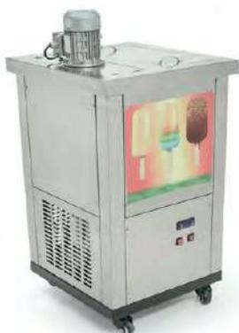
**FABRICADORA DE PALETAS PARA 1 MOLDE MARCA SNOWKY BY MIGSA.** GABINETE EN ACERO INOXIDABLE ARRANCADOR Y CONTROL DE TEMPERATURA, TÚNEL DE ENFRIAMIENTO CON AGITADOR INTEGRADO, PRODUCCIÓN DE 3,000 PALETAS POR DÍA, (INCLUYE 1 MOLDE EN ACERO INOXIDABLE) EQUIPO DE REFRIGERACIÓN AUTO CONTENIDO 0.8 KW. (1 H.P.) A 220 V / 60 HZ, CON REFRIGERANTE R404A, CON RUEDAS.
