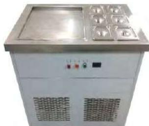
**MÁQUINA DE HELADO FRITO DE 1 TINA RECTANGULAR + 6 INSERTOS MARCA SNOWKY BY MIGSA.** GABINETE EN ACERO INOXIDABLE, UNA TINA DE FONDO PLANO DE 4.8 X 4.8 X 0.2 CM. INCLUYE 6 INSERTOS PARA TOPPING. PRODUCCIÓN DE HELADO FRITO DE 13 A 15 L/H. CONTROL DIGITAL DE TEMPERATURA. SISTEMA DE DESHIELO POR BOTÓN. COMPRESOR DE 750 W A 110 V / 60 HZ (MONOFÁSICO), CON REFRIGERANTE R410A. PESO NETO DE 50 KG.
