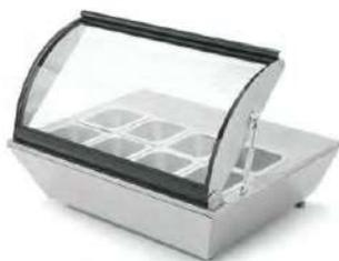
**BASE CALIENTE ELÉCTRICA DE 8 INSERTOS DE SOBRE MESA CON TAPA MARCA MIGSA.** GABINETE FABRICADO EN ACERO INOXIDABLE, TAPA DE CRISTAL ABATIBLE CON DESCANSO. 8 INSERTOS SEXTOS DE 10 CM DE FONDO INCLUIDOS. EQUIPO DE CALEFACCIÓN CON RESISTENCIA DE 500 W. TEMPERATURA DE 30 A 90°C, CONTROL DE TEMPERATURA DIGITAL CON INTERRUPTOR MANUAL. TIPO SOBRE MESA. CORRIENTE A 110 V / 60 HZ. PESO NETO: 17.5 KG.
