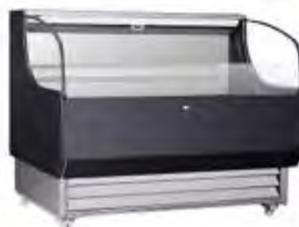
**TRAMO ABIERTO REFRIGERADO DE BAJO PERFIL MARCA MIGSA.** CUERPO EXTERIOR EN COLOR NEGRO CON BASE E INTERIOR EN ACERO INOXIDABLE. CAPACIDAD DE 370 L. PARTE SUPERIOR ABIERTA CON CORTINA NOCTURNA. ILUMINACIÓN LED. CONTROL DE TEMPERATURA DIGITAL PARA TRABAJAR DE 0 A 12°C. POTENCIA DE 1,375 W A 110 V / 60 HZ. REFRIGERANTE ECOLÓGICO R290. CHAROLA EVAPORADORA DE CONDENSADOS. 4 RUEDAS (2 CON FRENO). PESO NETO 157 KG.
