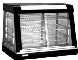
**VITRINA CALIENTE SOBRE MOSTRADOR MARCA MIGSA.** GABINETE ESMALTADO, PISO INTERIOR EN ACERO INOXIDABLE, CRISTALES RECTOS CON PUERTAS DESLIZABLES AL FRENTE Y PARTE POSTERIOR, CUBIERTA EN ACERO INOXIDABLE, 3 NIVELES DE ACOMODO DE PRODUCTOS Y EXHIBICIÓN, CONTROL DE TEMPERATURA AJUSTABLE DE 30 A 90°C. TERMÓMETRO AL FRENTE, INDICADOR DE TEMPERATURA. POTENCIA DE 1,840 W A 110 V / 60 HZ. PESO NETO 33 KG.
