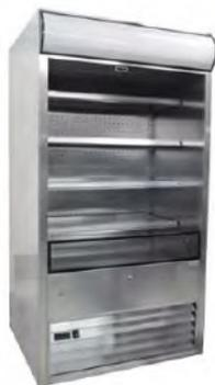
**MURAL DE AUTOSERVICIO REFRIGERADO MARCA MIGSA.** FABRICADO EN ACERO INOXIDABLE, REJILLA INFERIOR Y ENTREPAÑOS EN ACERO INOXIDABLE, CON 4 ENTREPAÑOS Y PISO, CAPACIDAD DE 530 L. PARA TRABAJAR A TEMPERATURAS DE 2 A 10°C, CORTINA NOCTURNA. CONTROL DIGITAL DE TEMPERATURA CON DISPLAY. ILUMINACIÓN LED BRILLANTE EN CADA ENTREPAÑO, SISTEMA DE ENFRIAMIENTO POR CORTINA DE AIRE, DESHIELO AUTOMÁTICO, POTENCIA DE 1,380 W A 110 V / 60 HZ. REFRIGERANTE R404A, PESO BRUTO 160 KG. PESO NETO 139 KG.
