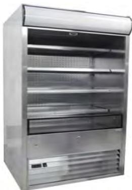
**MURAL DE AUTOSERVICIO REFRIGERADO MARCA MIGSA.** FABRICADO EN ACERO INOXIDABLE, REJILLA INFERIOR Y ENTREPAÑOS EN ACERO INOXIDABLE, CON 4 ENTREPAÑOS Y PISO, CAPACIDAD DE 1050 L. PARA TRABAJAR A TEMPERATURAS DE 2 A 10°C, CORTINA NOCTURNA, CONTROL DIGITAL DE TEMPERATURA CON DISPLAY. ILUMINACIÓN LED BRILLANTE EN CADA ENTREPAÑO, SISTEMA DE ENFRIAMIENTO POR CORTINA DE AIRE, DESHIELO AUTOMÁTICO. POTENCIA DE 1,870 W A 220 V / 60 HZ / 2 F. REFRIGERANTE R404A PESO NETO 284 KG.
