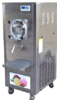
**MÁQUINA PRODUCTORA DE HELADO DURO MARCA SNOWKY BY MIGSA.** GABINETE EN ACERO INOXIDABLE, PANEL DE CONTROL DIGITAL CON LUZ LED, CON BOTONES PARA AJUSTAR EL TIEMPO Y LAVADO. CILINDRO CON CAPACIDAD DE 15 L CON AGITADOR DE ACERO INOXIDABLE. PRODUCCIÓN DE 40 L/H. TAPA FRONTAL DE ACRÍLICO CON CARGADOR Y SALIDA DE PRODUCTO PARA SU FÁCIL VISUALIZACIÓN. COMPRESOR DE 3,300 W A 220 V / 60 HZ / 2 F (BIFÁSICA). REFRIGERANTE R410A PARA RÁPIDA CONGELACIÓN. PESO NETO DE 140 KG. PESO BRUTO DE 155 KG.
