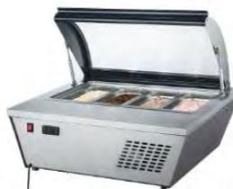
**BASE CONGELADA PARA HELADOS DE 4 INSERTOS SOBRE MESA CON TAPA MARCA MIGSA.** GABINETE EN ACERO INOXIDABLE TAPA DE CRISTAL ABATIBLE CON DESCANSO, 4 INSERTOS TERCIOS DE 10 CM DE FONDO INCLUIDOS, EQUIPO DE CONGELACIÓN CON TEMPERATURA AJUSTABLE DE -18 A -25°C, CONTROL DE TEMPERATURA DIGITAL CON INTERRUPTOR MANUAL, TIPO SOBRE MESA, CON CORRIENTE A 110 V, 60 HZ. PESO NETO DE 38 KG.
